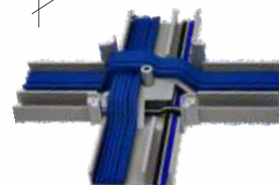
Exemplo de passagem dos cabos com uso da blindagem eletromagnética.
